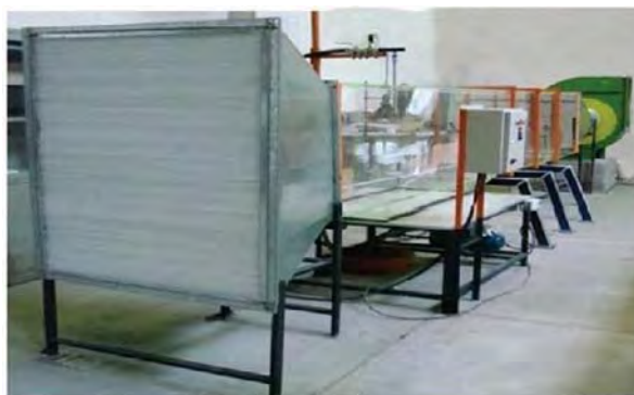
شکل ۴. تونل باد ساخته شده توسط فتاحی و همکارانش در سال ۱۳۹۲
