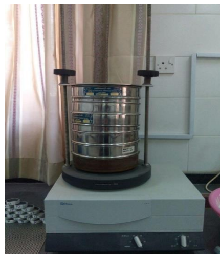
شکل ۱- الکها و دستگاه لرزاننده
