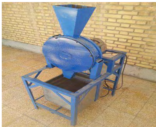
شکل (۱۰) دستگاه آسیاب استفاده شده جهت آسیاب هسته های خرما
