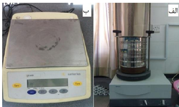
شکل (۱) الف: الک ها و لرزاننده، ب: ترازو Sartorius مدل GE4101
