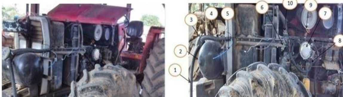
شکل ۱- نحوه قرار گرفتن تجهیزات سیستم سوخت ترکیبی گازوئیل و گاز LPG بر روی تراکتور مسی فرگوسن ۳۹۹.
